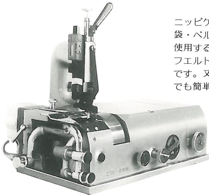
ニッピゲージ付皮漉機は、靴・鞄・袋物・手袋・ベルト・財布等の製品のミシン加工前に使用する機械であり、一般皮革・ビニール・フェルト・ゴム等の平漉き、ヘリ漉きに最適です。又、下記の様な特長があり初心者の方でも簡単に操作が出来ます。
