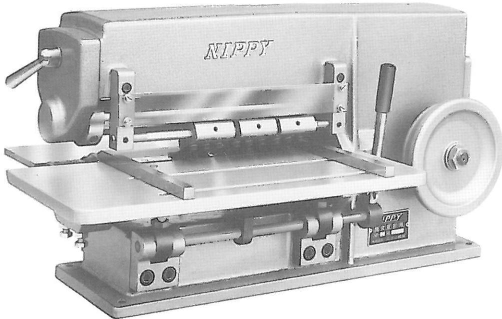
本機は一般皮革・ビニール・ゴム・スポンジ・フェルト等の紐類の裁断に使用する機械です。座金(別製)の交換によりご希望の裁断幅が容易に得られます。本機には下記の特長があります。
